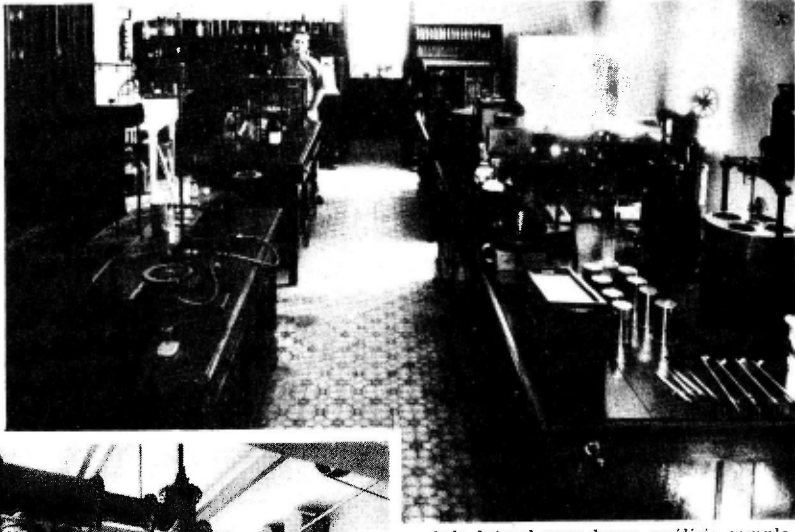
Sala lateral para hacer análisis completos físico-químicos de materias primas, principalmente maltas y lúpulo. En esta sala se analizan todas las materias primas que usamos en nuestra fabricación de cerveza, para controlar la calidad de las mismas, ya que seleccionamos siempre las materias primas de mejor calidad, no pensando nunca en la economía para la elaboración de nuestros productos, pues éstas deben de hacerse industrialmente en otros sectores y nunca en los productos que se emplean en la elaboración de las cervezas.
